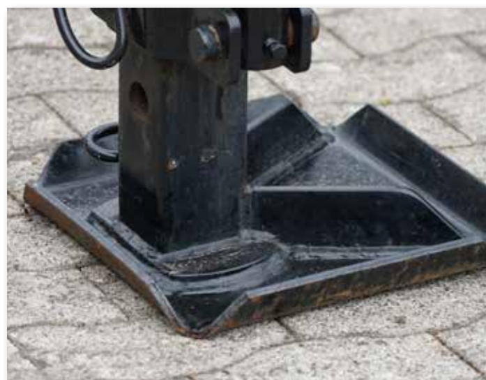
Praktische Ablagen für Leiter und Kantenschoner und besonders breite Bodenplatten am unteren Ende der seitlichen Stützbeine
