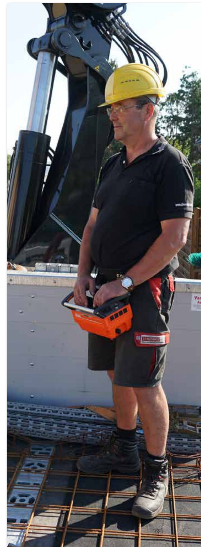
Die ATLAS-Lademaschinen 190.2E lassen sich sehr leicht und feinfühlig bedienen, was durch die Funkfernbedienung mit linearen Steuerhebeln unterstützt wird
