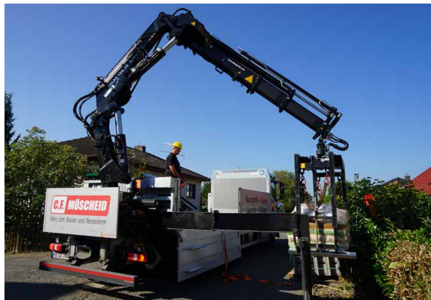
Das Standsicherheitsystem EAW 4 arbeitet völlig unabhängig vom Neigungswinkel des LKW, was auch den Einsatz an großen Steigungen und auf schrägen Standflächen ermöglicht
