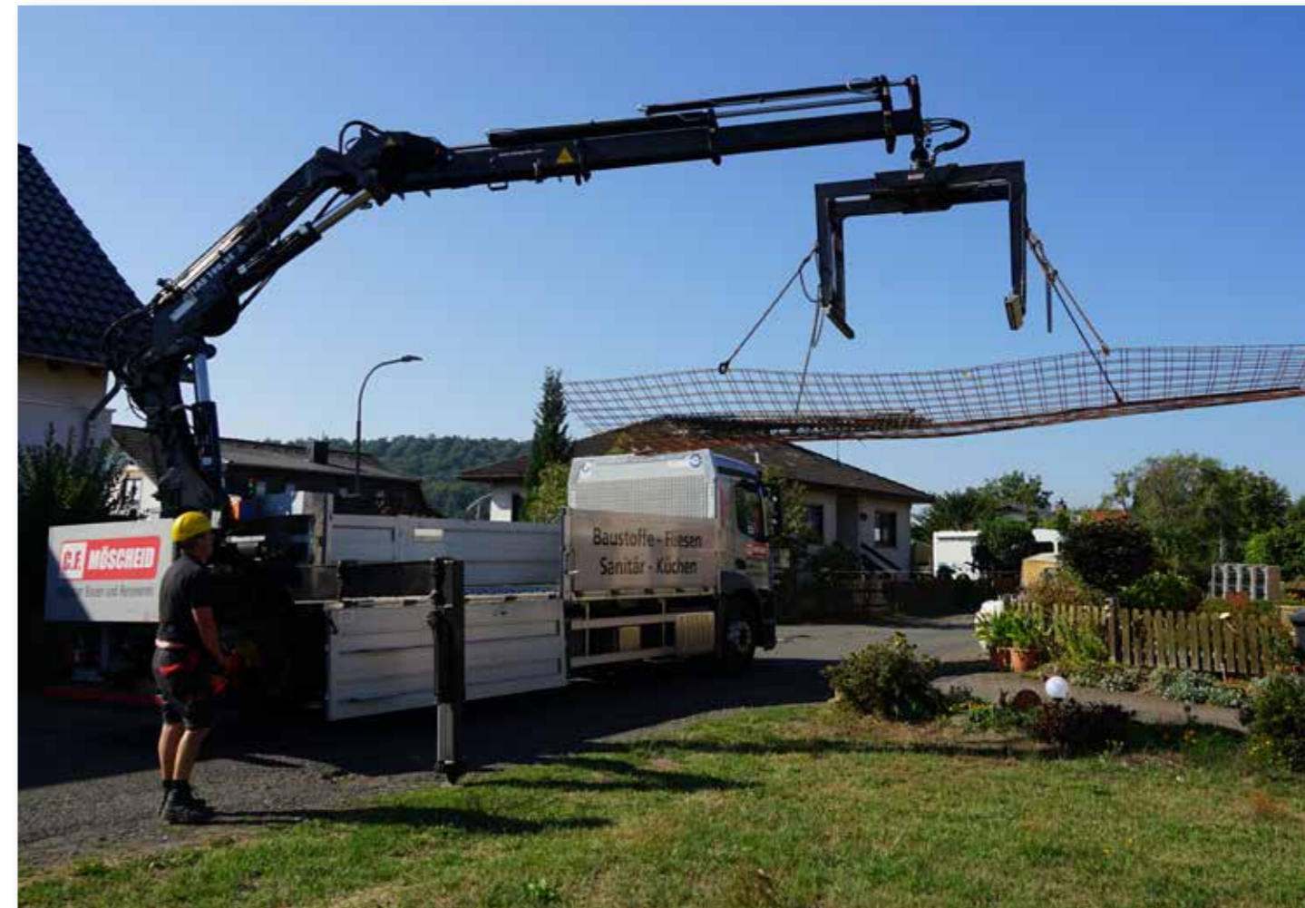
Die ATLAS-Ladekrane verfügen über das von ATLAS entwickelte Standsicherheitsystem EAW 4 mit elektronischer Stützweitenüberwachung, das den Ausschub der seitlichen Auszugskästen stufenlos misst und die Leistung des Krans daran anpasst
