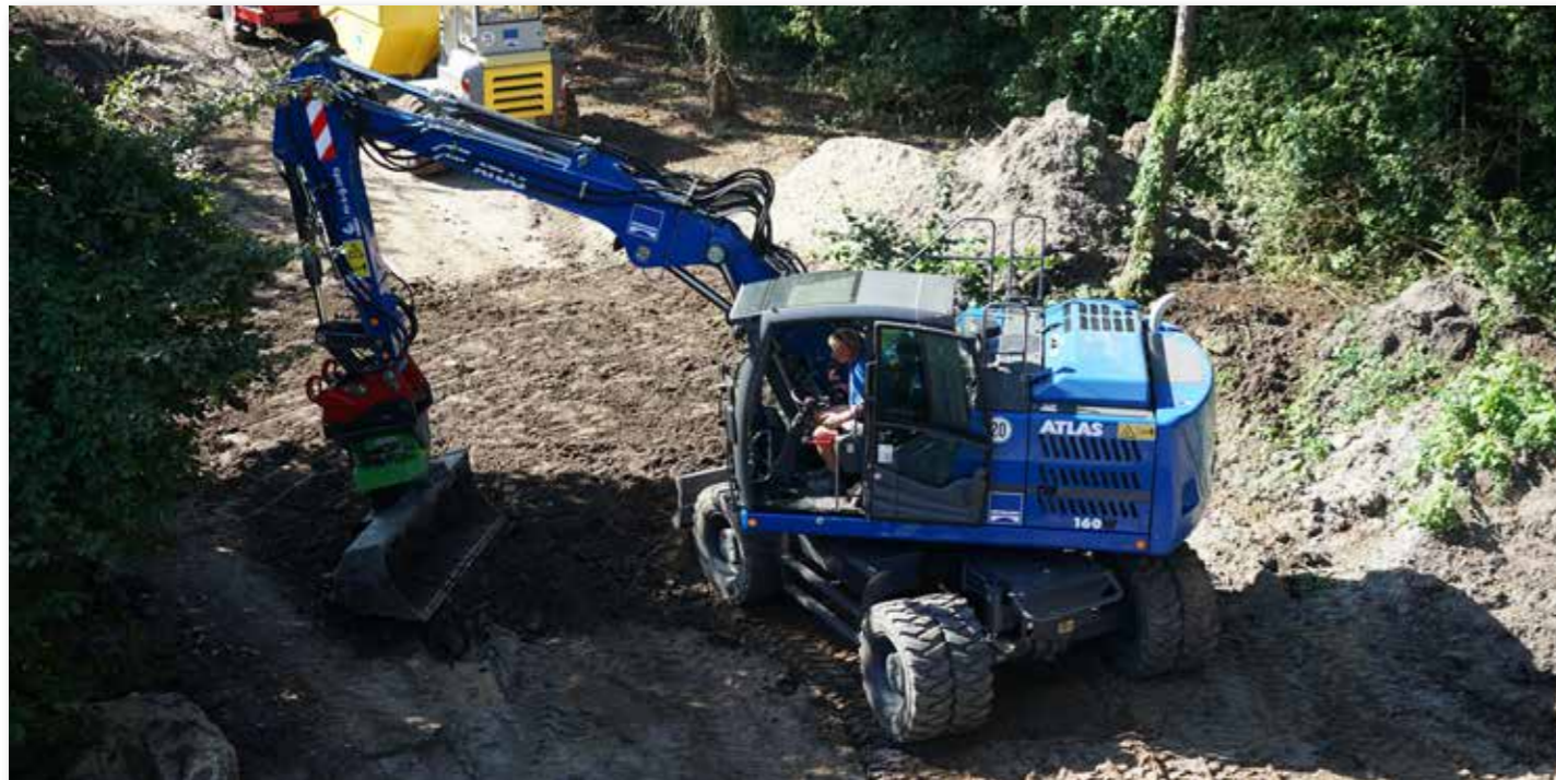
Der ATLAS 160W blue Mobilbagger verfügt über eine auf 2,75 Meter erweiterte Spurbreite für mehr Standsicherheit
