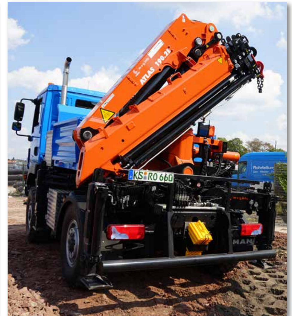
Der ATLAS 190.2E verfügt über 4 hydraulische Ausschübe, mit denen sich eine Reichweite von 12,4 Metern realisieren lässt
