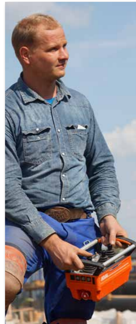
Durch HBC-Fernbedienung kann der Kranbediener auch die Funktion des Vorrichters übernehmen
