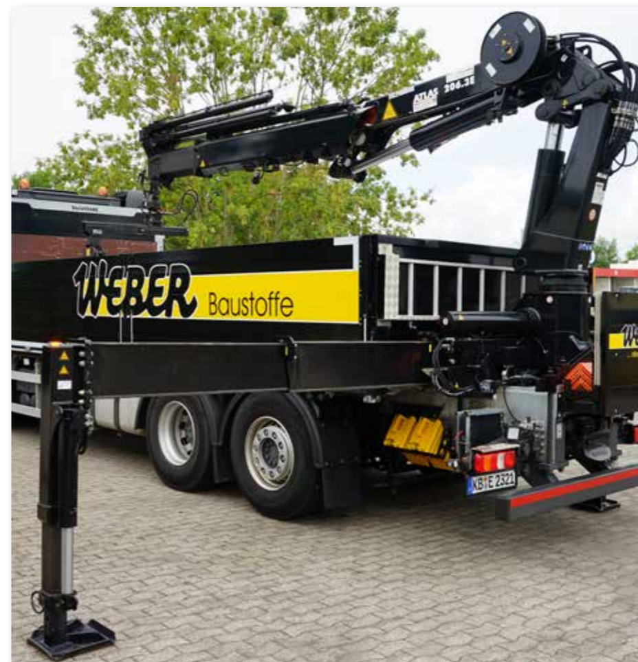
Das von ATLAS im Jahr 2014 vorgestellte AHMEKO Standsicherheitsystem misst über einen oberhalb der Achse angebrachten Sensor den Abstand zum Boden und errechnet daraus die aktuelle Fahrzeugneigung. Vor diesem Hintergrund kommt das System ganz ohne Messung der Abstützlängen aus
